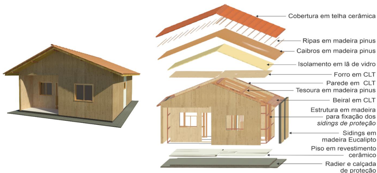
Figura 4.7 - Vista 3D e esquemática do modelo em painéis de madeira massiva CLT.
