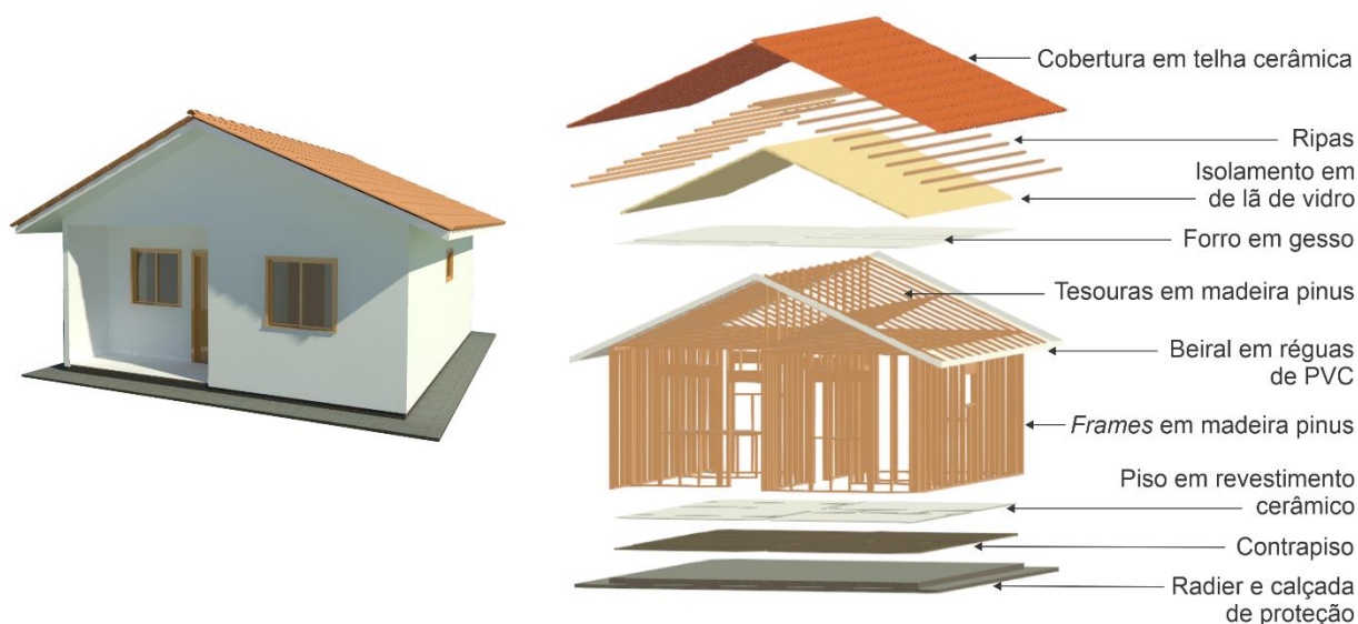
Figura 4.5 - Vista 3D e esquemática do modelo em Wood frame.
